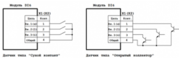
Схема подключения субмодуля дискретных входов DI6
